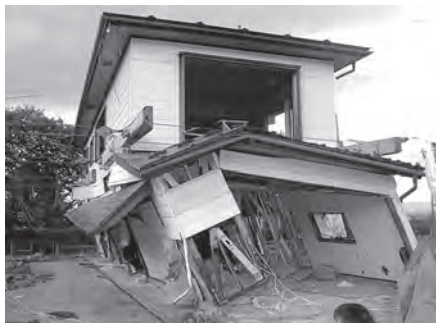
図表24 実在住宅静加力引き倒し実験
