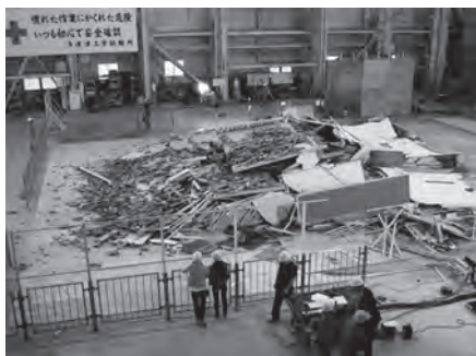
図表26 実在住宅移築復元振動破壊実験(2)
