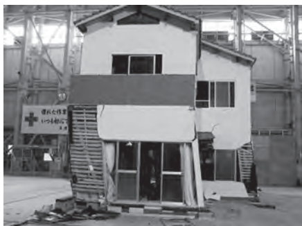
図表25 実在住宅移築復元振動破壊実験(1)
