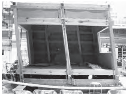
図表21 伝統貫土壁供試体静加力実験(1)
